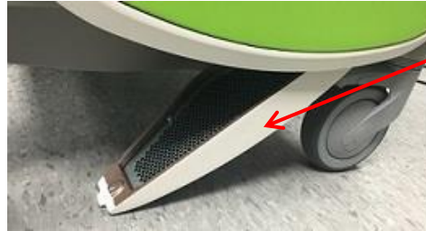
Kuva 69: Alemman ilmansuodattimen aukko
