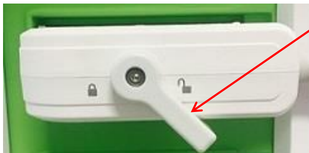
Kuva 30: Avattu anturin liittimen lukitussäädin avattuna
